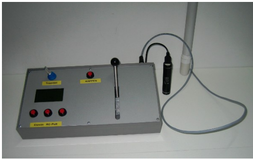
Das Fernsteuerpult mit angesteckter Stromversorgung und Antenne (nur teilweise sichtbar)
